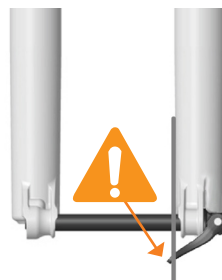
ONJUIST GEÏNSTALLEERDE AS
