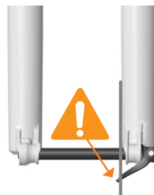
PERNO INSTALLATO IN MODO ERRATO
