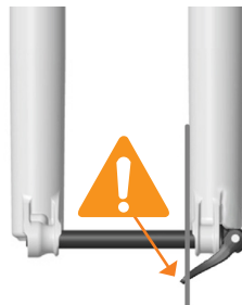
EIXO INSTALADO INCORRETAMENTE
