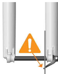
AXE INSTALLÉ DE MANIÈRE INCORRECTE
